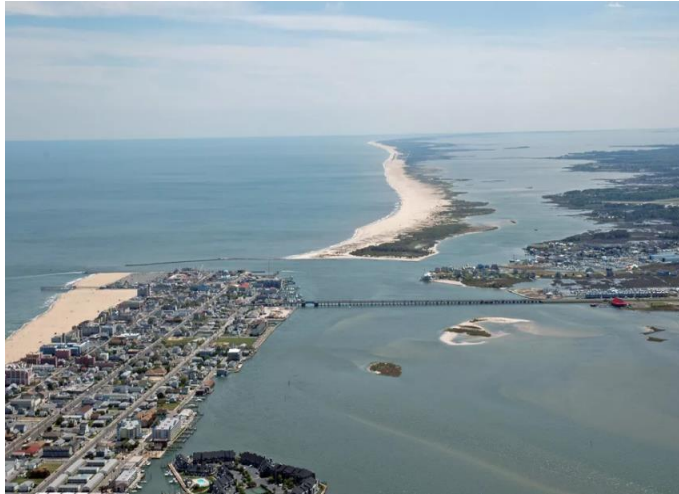
Gambar 3.5 Stabilisasi saluran masuk berdekatan dengan Pantai Nasional Pulau Assateague, Maryland dan Virginia. (Sumber:Foto oleh Jane Thomas, Perpustakaan Gambar UMCES/IAN)
